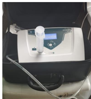
Figura 2: Extração do ozônio através do gerador e cilindro de oxigênio
