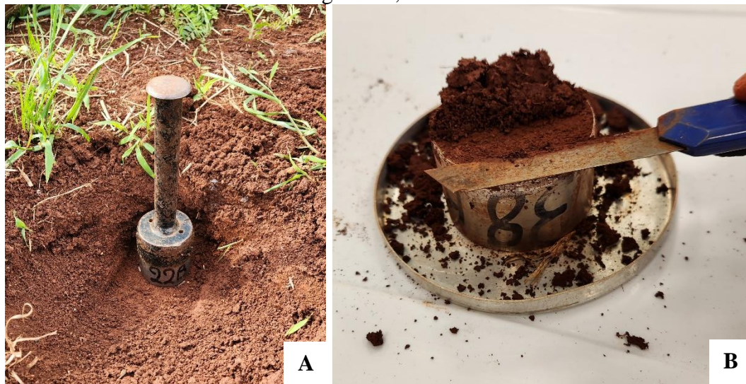
Figura 4 - Coleta das amostras indeformadas (0,1 – 0,2m) pelo método do cilindro volumétrico (A); Retirada do excesso de solo da amostra, realizada no laboratório (B), Cerro Largo – RS, 2023.
