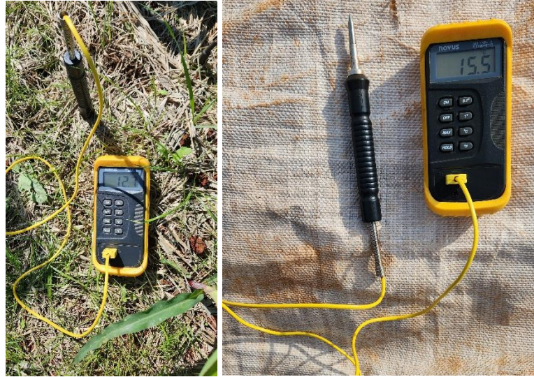
Figura 3 - Monitoramento da temperatura do solo através do Termopar Tipo K, Cerro Largo – RS, 2023.
