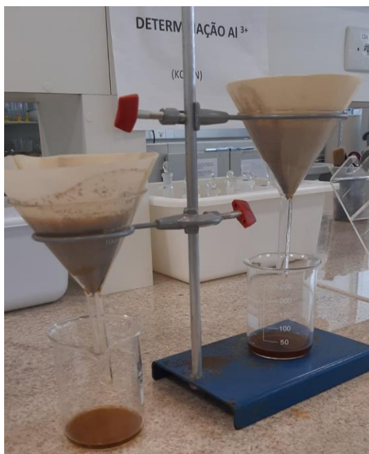
Figura 2 - Filtragem da suspensão para determinação da CE
