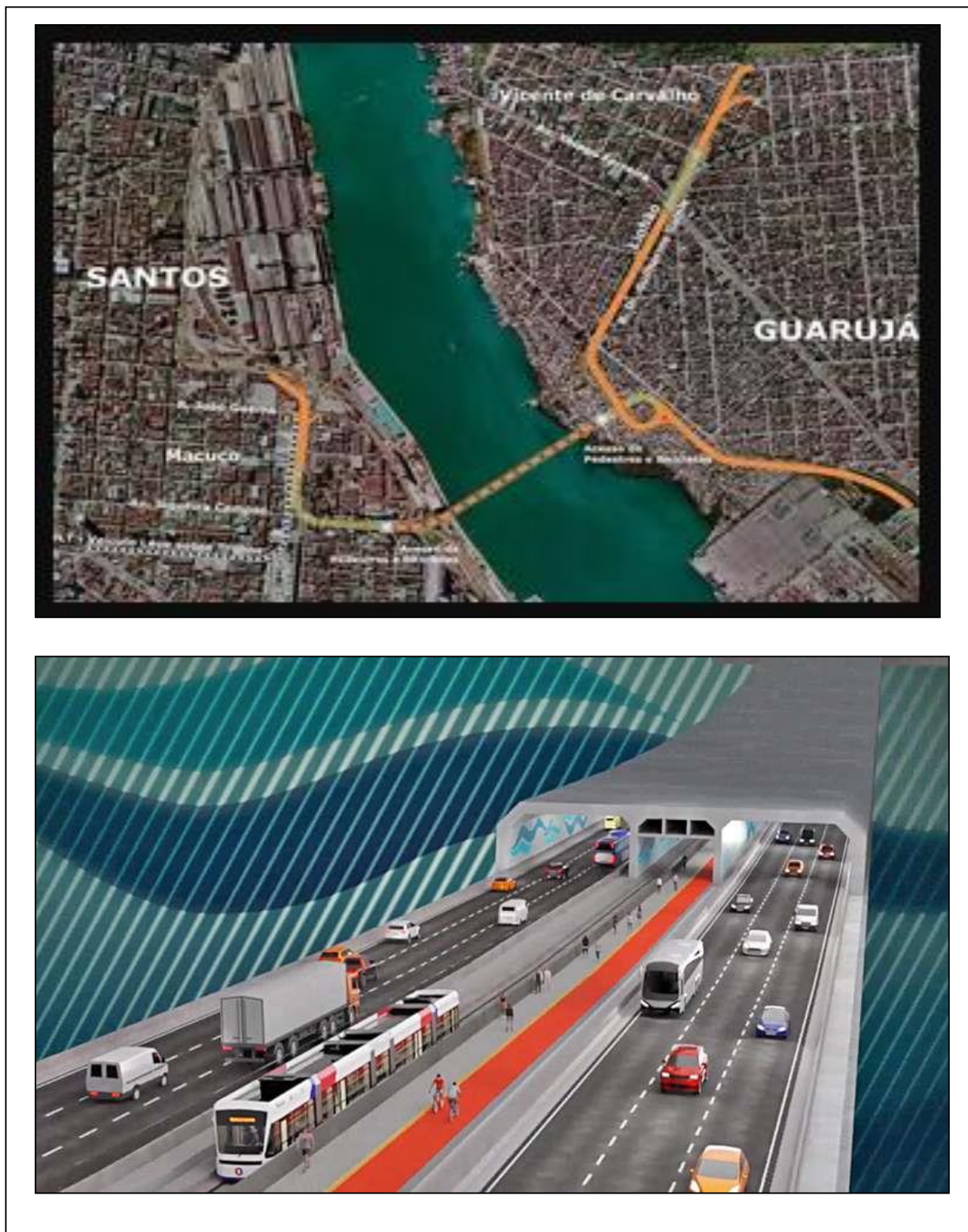
Figura 19: Localização da Obra e Projeto de Secção de Entrada do Túnel Submerso Santos – Guarujá
