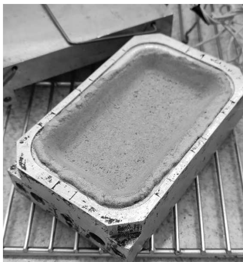
Figura 2. Molde em formato de bandeja utilizado para produção das embalagens
