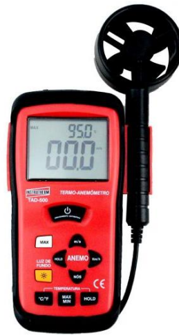
Figura 21 – Anemômetro digital com hélice remota.
