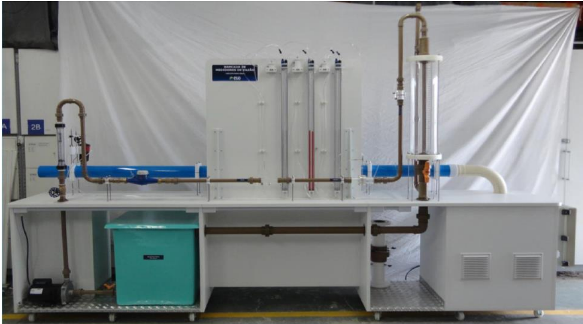
Figura 19 - Bancada de medidores de vazão: circuito água.
