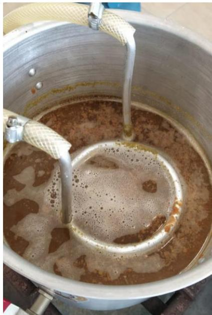
**Figura 6** - Resfriamento utilizando o *chiller*.
