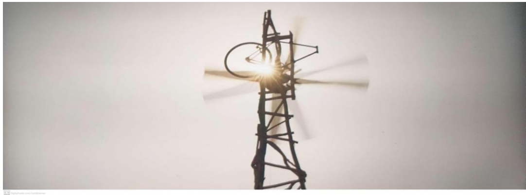
Figura 3: O moinho de vento construído com o quadro de uma bicicleta.
