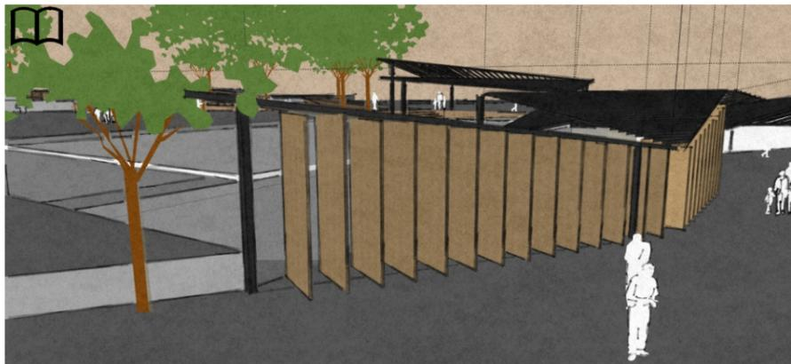
Fig. 11.2: Painéis de fechamento em algumas partes da cobertura
