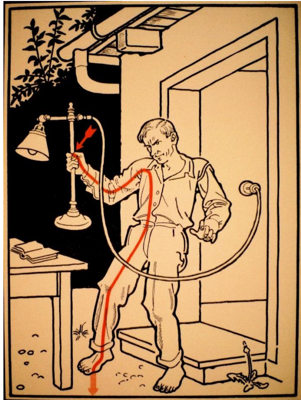
Figura 06: Ilustração da passagem de corrente elétrica pelo tórax
