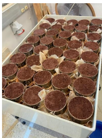
Figura 4 – Método da Mesa de Tensão, no Laboratório de Física e Pedologia do Solo da Universidade Federal da Fronteira Sul – campus Cerro Largo, 2023.
