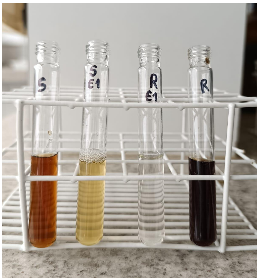
S: Efluente sintético bruto, SE1: Ensaio com efluente sintético em reator de 400 mL, RE1: Ensaio com efluente real em reator de 400 mL, R: Efluente real bruto. Fonte: Elaborado pela autora (2025).
