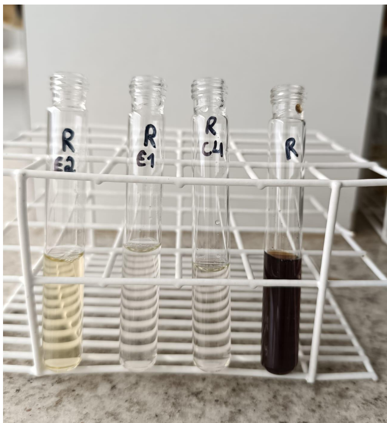
RE2: Ensaio com efluente real em reator de 800 mL, RE1: Ensaio com efluente real em reator de 400 mL, RC4: Ensaio com efluente real em reator de 220 mL, R: Efluente real bruto. Fonte: Elaborado pela autora (2025).
