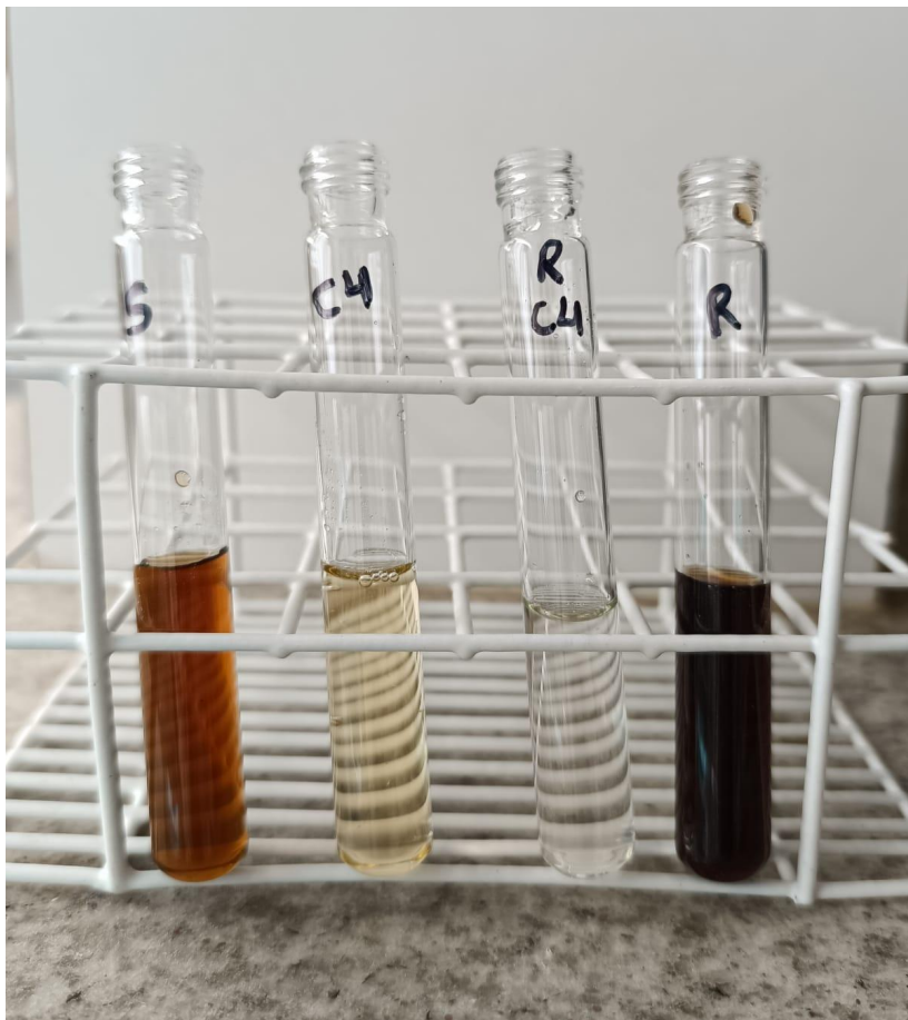
Figura 06 - Amostra de efluente real após eletrofloculação, comparada ao efluente sintético.
