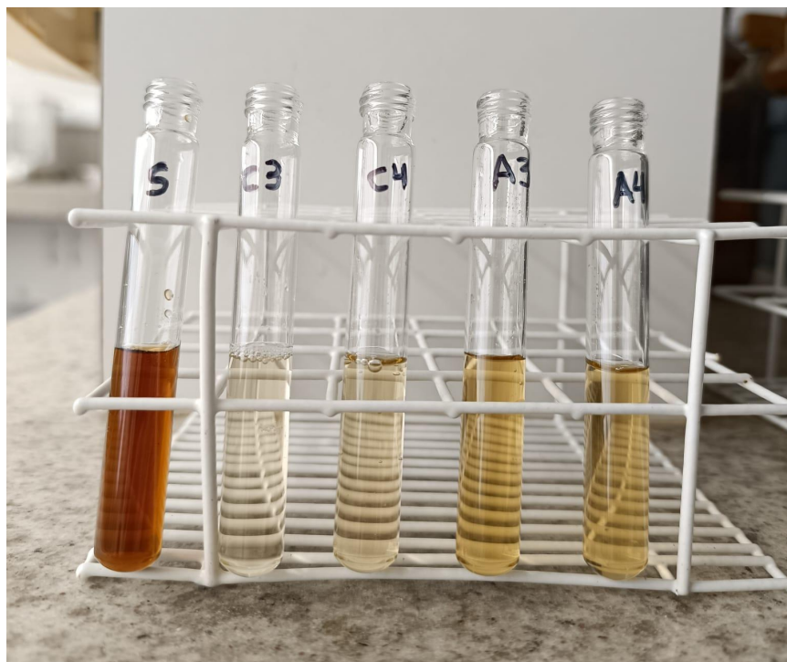
S: efluente sintético bruto, C3: Eletrodo de cobre, com corrente aplicada de 300 mA, C4: Eletrodo de cobre, com corrente aplicada de 400 mA, A3: Eletrodo de alumínio, com corrente aplicada de 300 mA, A4: Eletrodo de alumínio, com corrente aplicada de 400 mA. Fonte: Elaborado pela autora (2025).
