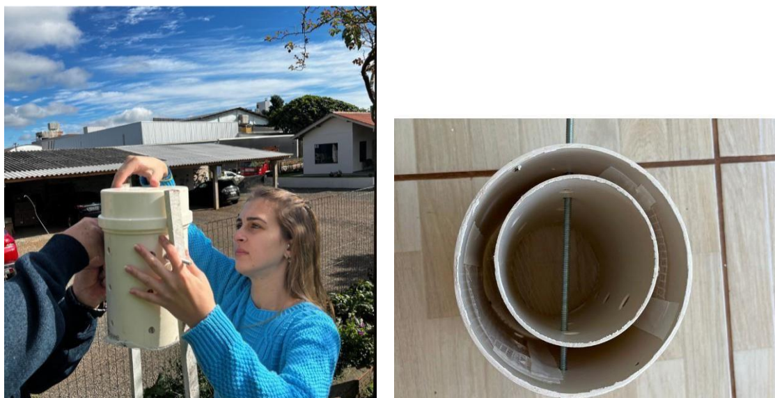
Figura 28 - Instalação dos miniabrigos
