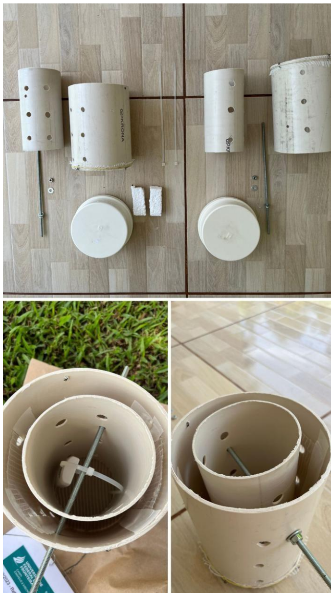
Figura 29 - Materiais utilizados na montagem dos abrigos meteorológicos
