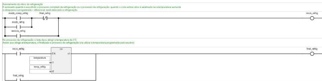
Figura 3.6 – Função da refrigeração (Fonte: Autor)
