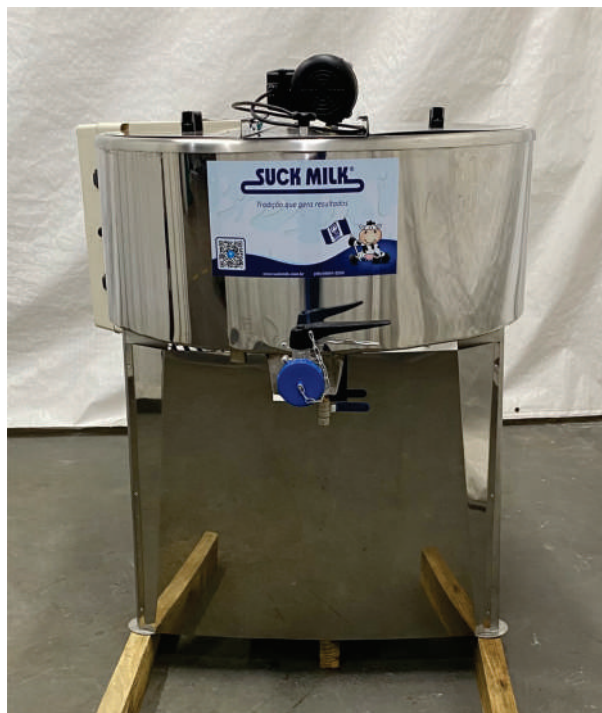
Figura 3.1 – Pasteurizador lento - vista frontal (Fonte: Autor)
