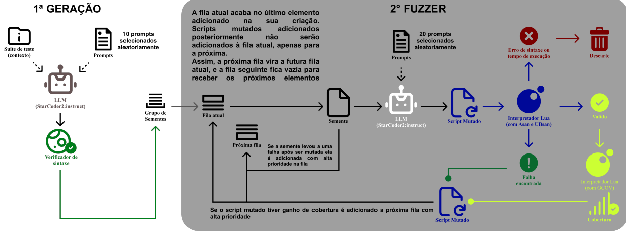
Figura 1. Fluxo de trabalho da metodologia proposta: (1) Fase de Geração de Sementes utilizando contexto da suíte de testes; (2) Ciclo de Fuzzing com orquestração de filas e análise de cobertura/sanitização.
