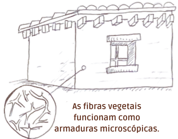
A rede de fibras distribui as tensões de forma homogênea, reduzindo a formação de fissuras.
