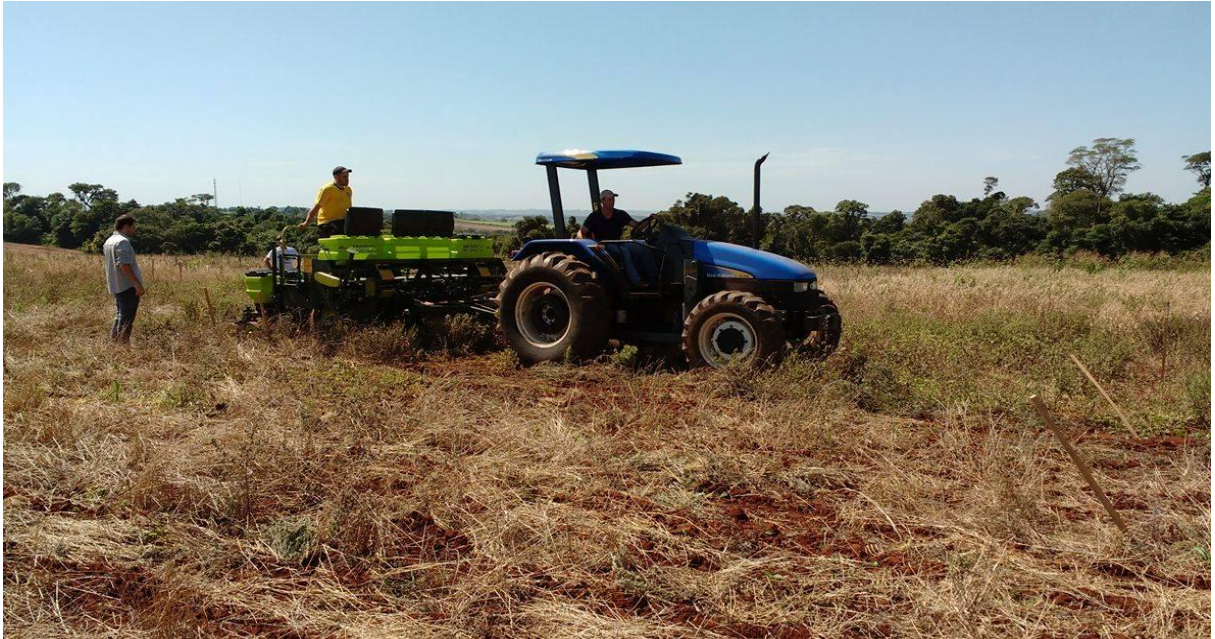
Figura 3 - Conjunto Trator mais semeadora utilizado para a realização da semeadura da soja.
