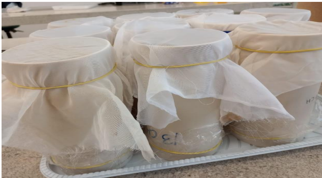
Figura 2 – Tubos de PVC 150 mm, com as duas extremidades fechadas, a inferior com filme de PVC presa com elástico de borracha e a superior com tecido voil, também presas com elástico.
