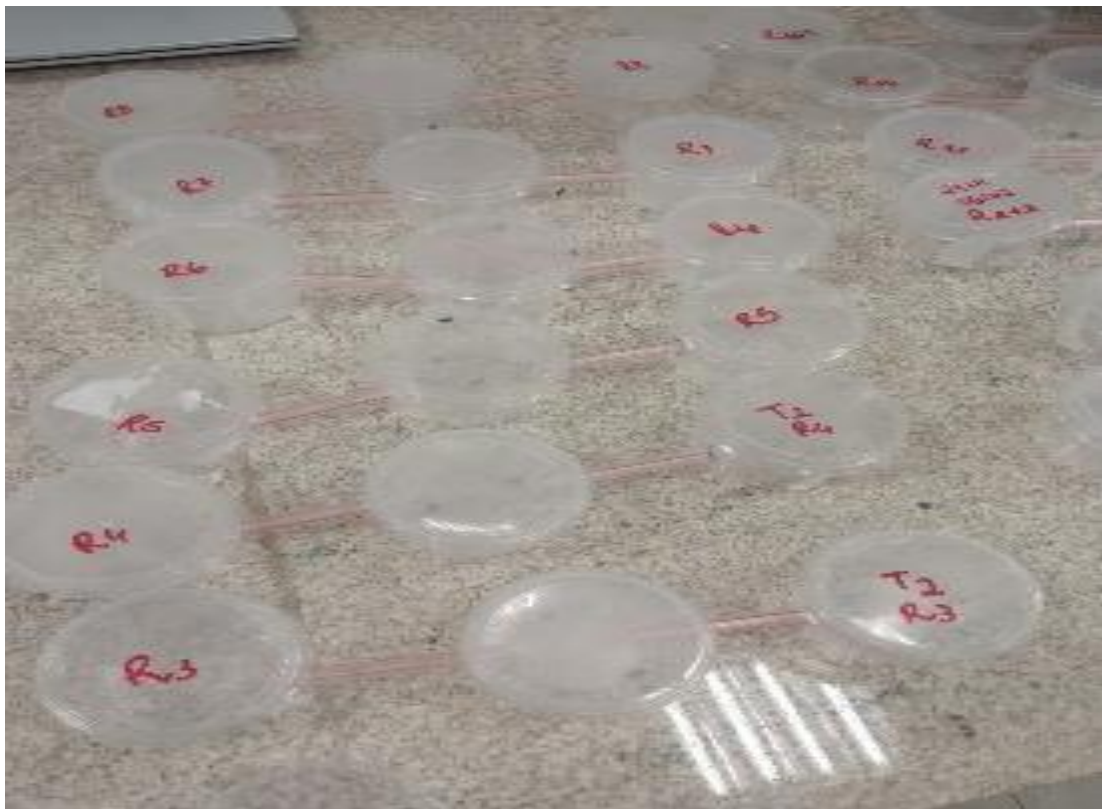
Figura 1 - Arenas do experimento preferência alimentar feitas com potes de 145 ml, ligados por um canudo de milkshake de 5 cm.
