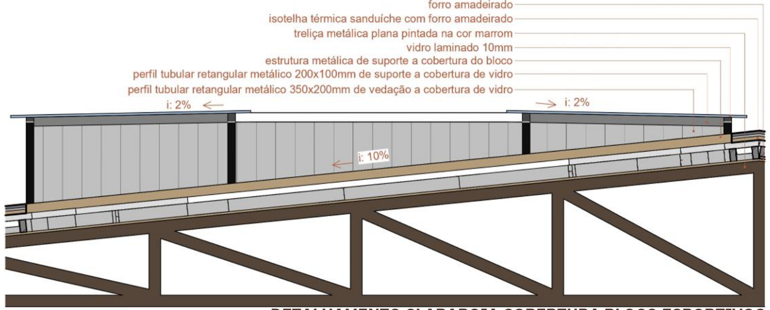
DETALHAMENTO CLARABOIA COBERTURA BLOCO ESPORTIVO escala 1:50
