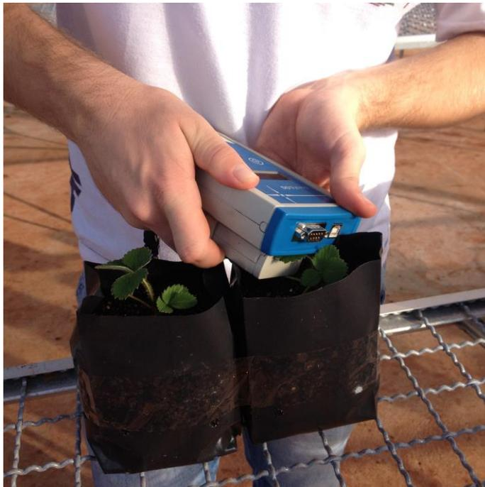
**Figura 7.** Leitura do teor de clorofila por meio do medidor indireto de clorofila SPAD-502
