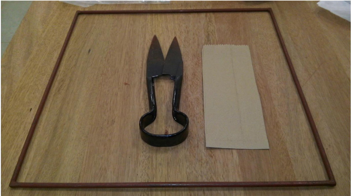
Figura 6: Quadro metálico com dimensões de 50 x 50 cm (0,25 m 2 )
