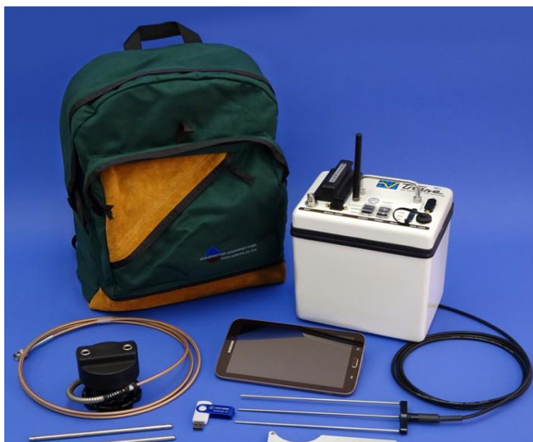
Figura 8 - Equipamento utilizado para determinação da umidade do solo durante o ciclo da cultura.
