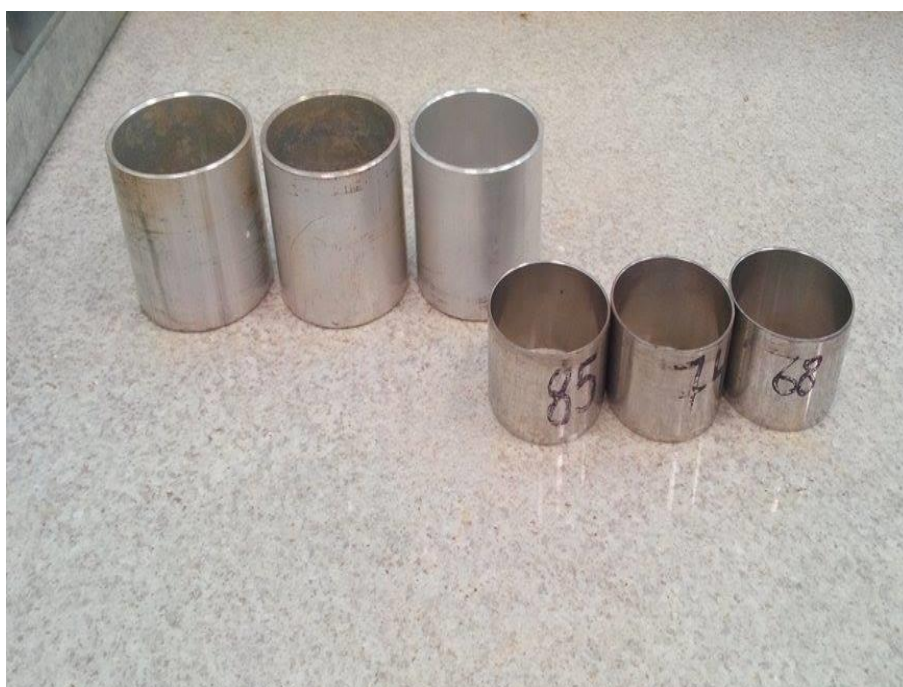
Figura 6 - Anéis de aço inox utilizados para coleta de amostras.
