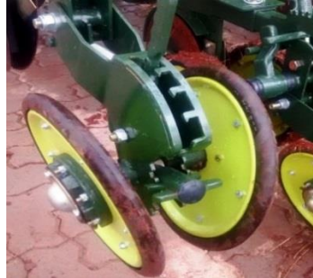
Figura 5 - Mecanismo de adensamento em "V".
