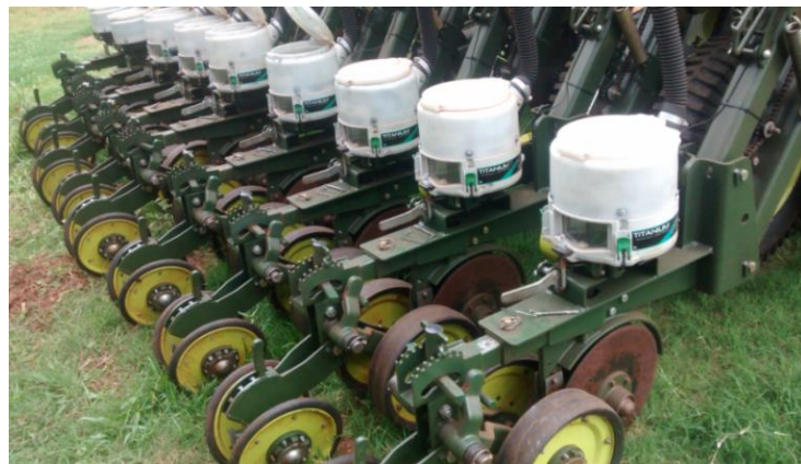
Figura 3 - Semeadora equipada com reservatórios individuais de semente.
