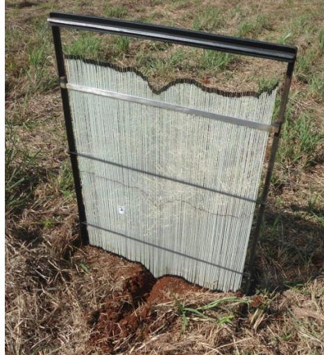
Figura 6 - Perfilômetro desenvolvido para o experimento.
