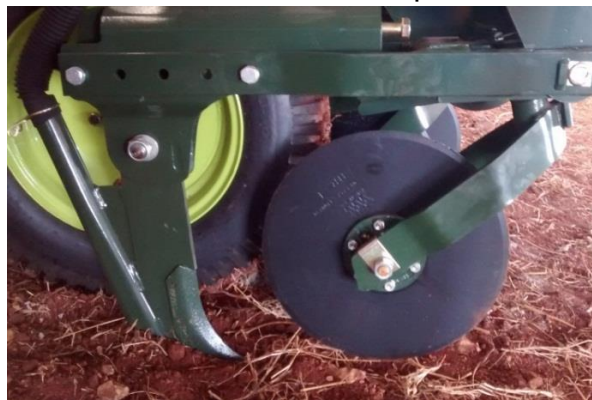
Figura 1- Haste sulcadora em uma semeadora de precisão.
